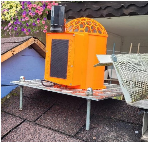
Abb.4.: Anwendungen: Regenmengenmesssystem mit hochgenauer Wägetechnologie und Bodenmessung zur Erfassung der Aufnahmekapazität des Bodens
