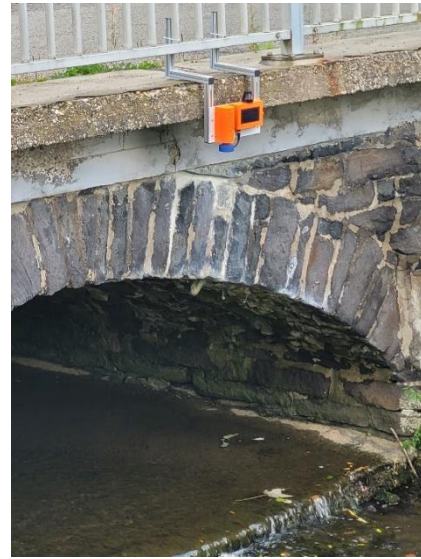
Abb.3.: Anwendungen: Gewässer- Pegelmessung mit Ultraschallsensor
