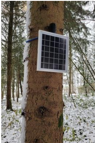
Abb.5.: Anwendungen: Langzeitüberwachung des Baumwachstums mittels Seilzugsensor
