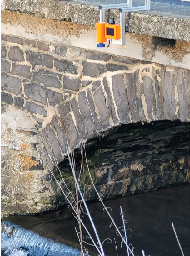
Abb.1: Gewässer- Pegelmessung mit Ultraschallsensor
