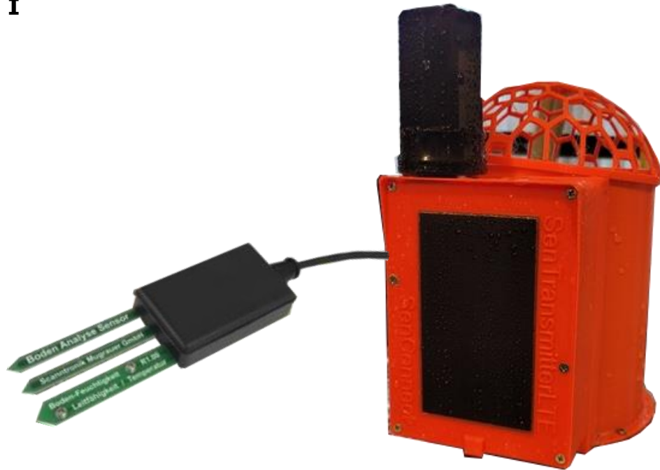
Abb.3.: SenTransmitter mit einem Regenmessgerät und einem Bodensensor ausgerüstet, liefert qualitativ hochwertige Daten, mit denen das KI-Modell gelehrt werden kann
