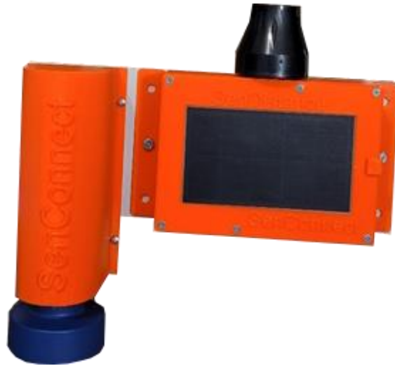
Abb.4.: SenTransmitter mit einem Ultraschallsensor ausgerüstet misst den Wasserpegel des Holzbaches
